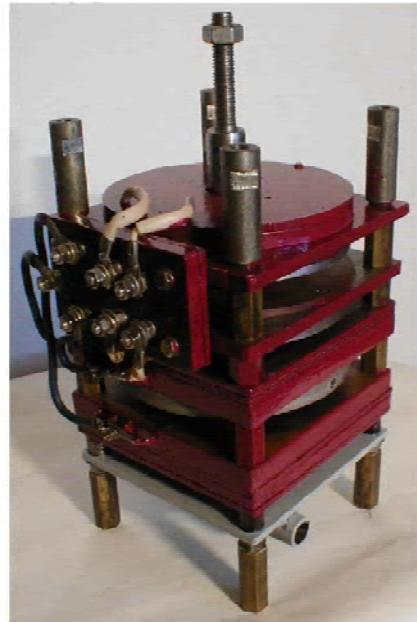
Рисунок 3 – Схема и внешний вид комбинированного привода с ИДМ и постоянными магнитами: 1 – шток привода; 2 – фланец; 3 – постоянный магнит; 4 – компенсационная катушка; 5 – ферромагнитный диск; 6 – стойка корпуса; 7 – катушка ИДМ; 8 – диск ИДМ
