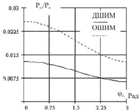
Рис. 5. Зависимости статических потерь от угла  $\varphi_2$
