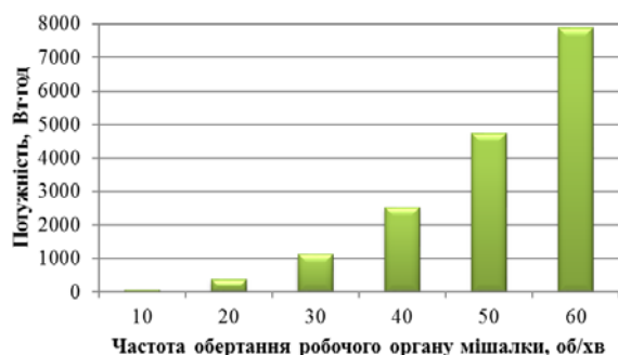
Рисунок 3. Витрата потужності електричним приводом від частоти обертання робочого органу дволопатевої двоярусної мішалки.
