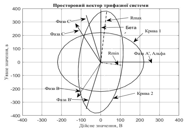
Рисунок 1. Просторовий вектор трифазної системи з наявністю однофазної несправності [8]
