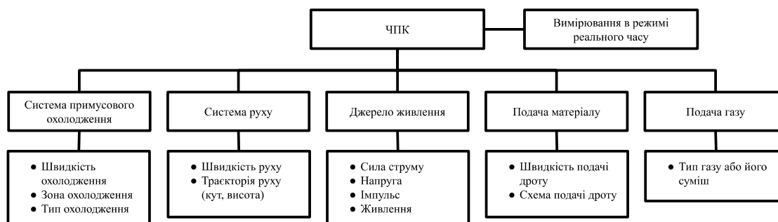
Рисунок 5. Структура та параметри компонентів апаратного забезпечення
