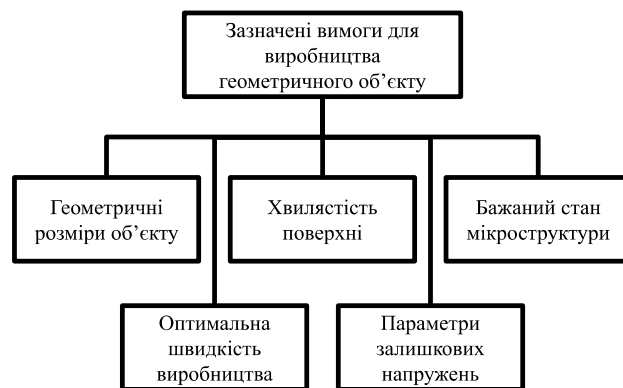
Рисунок 3. Вимоги до якості друку деталей
