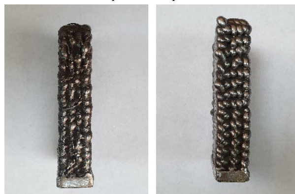
Рисунок 12. Експериментально отримані деталі використовуючи GMAW Standard (ліворуч) та GMAW CMT (праворуч)
