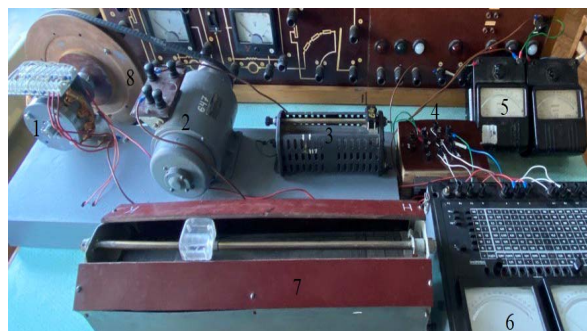
Рисунок 2. Загальний вигляд експериментального стенду 1 – торцевий генератор; 2 – привідний двигун; 3 – реостат регулювання збудження; 4 – комплект із випрямлячами та фільтрами; 5 – комплект приладів вимірювання в колі привідного двигуна; 6 – комплект приладів вимірювання торцевого генератора; 7 – навантаження торцевого генератора; 8 – вимірювач швидкості обертання торцевого генератора.
