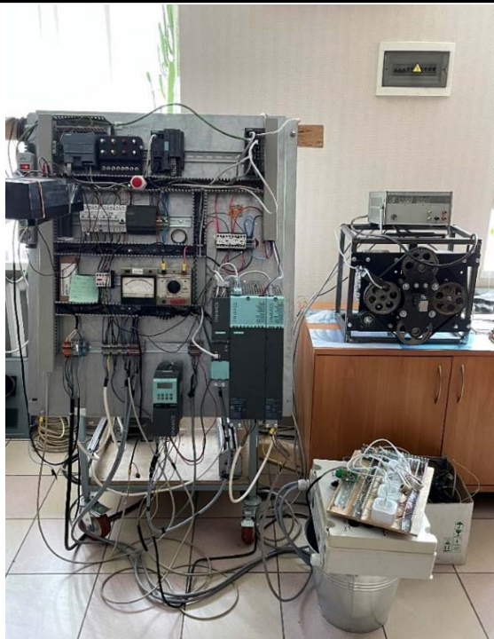
Рисунок 3. Фото стенду дослідження енергетичних властивостей приводів .
