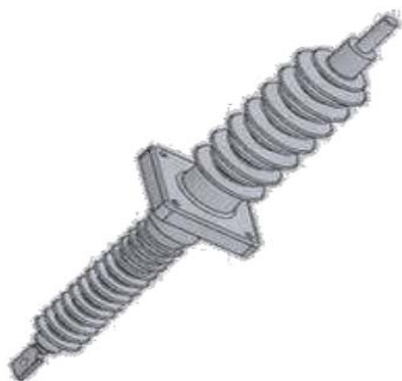
Рисунок 9. 3d-модель полімерного прохідного ізолятора в Autodesk AutoCAD
