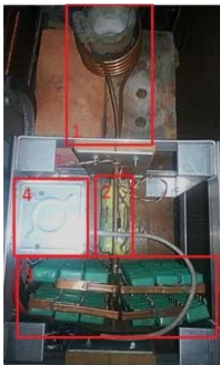
1 - індуктор з тиглем; 2 - узгоджувальний трансформатор; 3 - конденсаторна батарея; 4 - вузол для зняття параметрів КК
