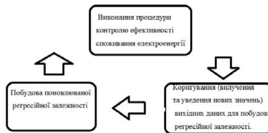
Рисунок 2. Алгоритм поновлення регресійної залежності для унормування споживання електроенергії
