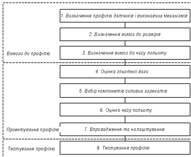
Рисунок 1. Покроковий процес створення модульного профілю МР-БПЛА
