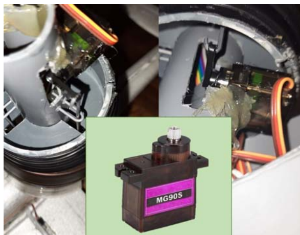
Рисунок 4. MG-90S та його інтеграція до стенду
