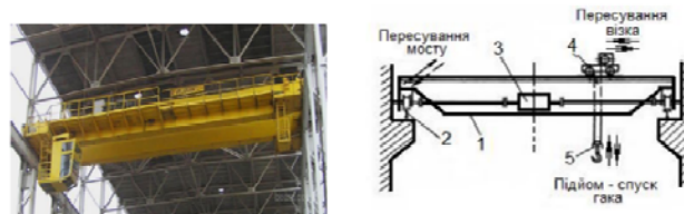
1 – міст; 2 – шляхи; 3 – механізм пересування; 4 – візок; 5 – гак
