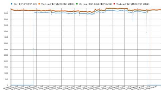
Рисунок 6. Приклад перерозподілу напруг при однофазному «металевому» замиканні на землю в мережі з ізолюваною нейтраллю
