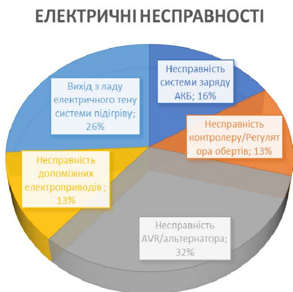
Рисунок 4. Розподілення електричних відмов
