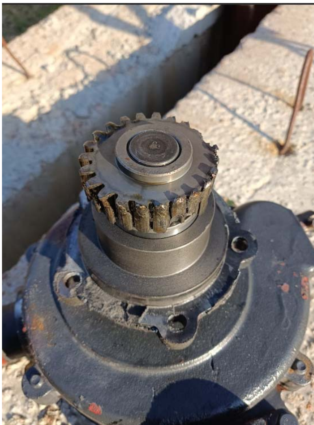
Рисунок 3. Руйнування шестерні приводу помпи охолодження генератора внаслідок заклинювання підшипника
